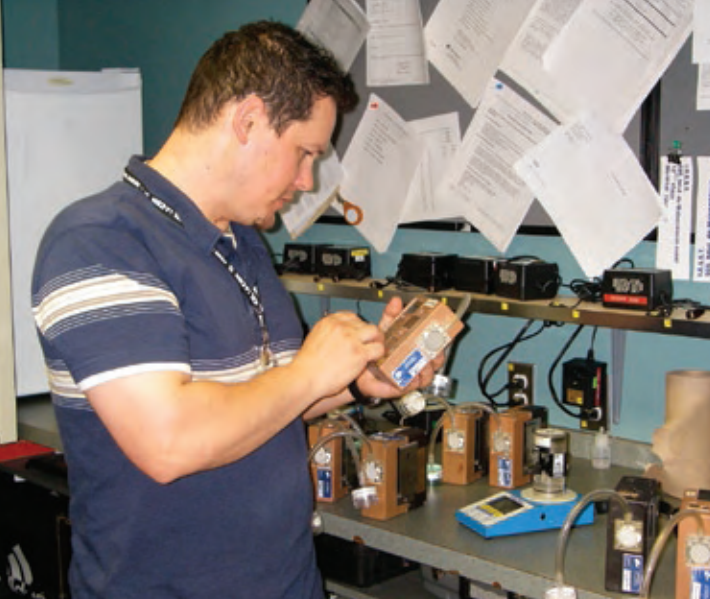
Stéphane Simard, technicien en hygiène du travail, calibre une pompe servant à mesurer les niveaux d'exposition des travailleurs aux contaminants présents dans l'air.
