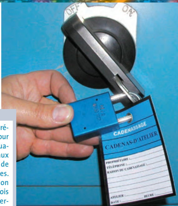
Cadenassage et étiquetage d'un sectionneur
