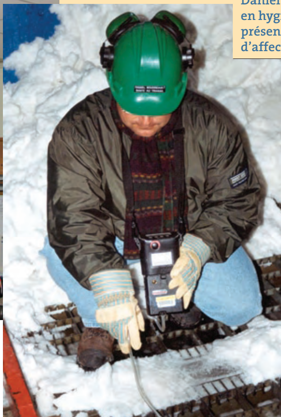
Karl Dupuis, technicien en hygiène du travail, vérifie l'efficacité du système de ventilation.
