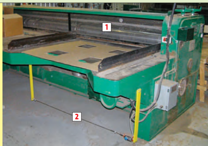
1. Protecteur fixe ; 2. Câble d'arrêt d'urgence
