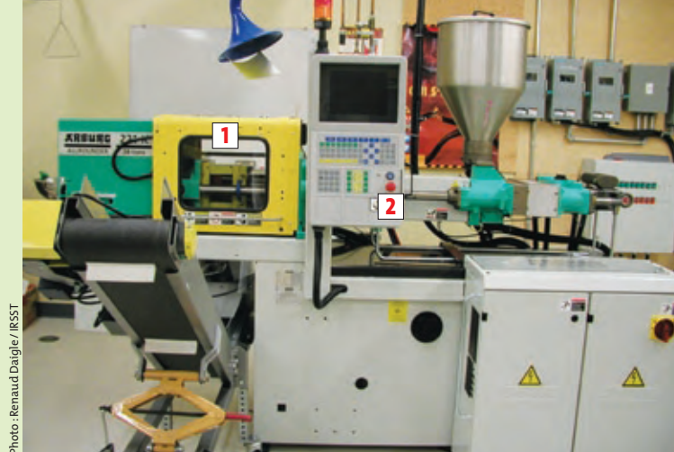
1. Protecteur mobile avec interverrouillage ; 2. Bouton d'arrêt d'urgence
