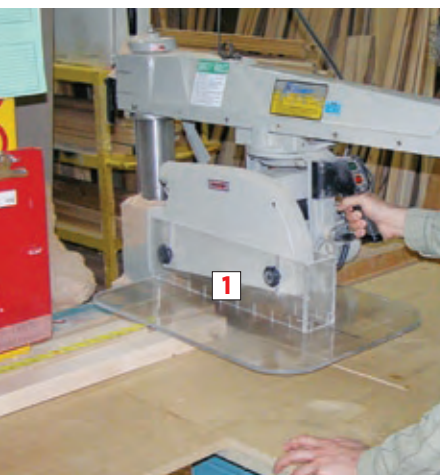
1. Protecteur fixe en Lexan ; 2. Protecteur à fermeture automatique ; 3. Couteau diviseur ; 4. Aspiration à la source ; 5. Guides ; 6. Bâtons poussoirs
