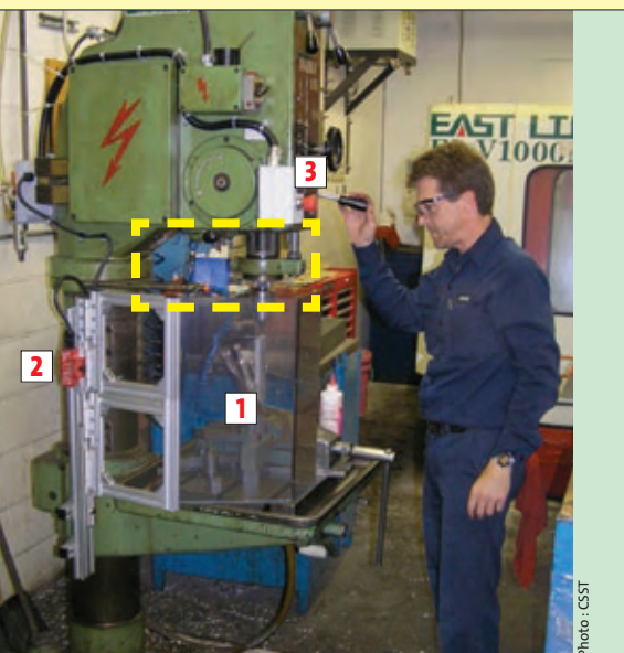
1. Protecteur mobile ; 2. Dispositif d'interverrouillage ; 3. Bouton d'arrêt d'urgence
