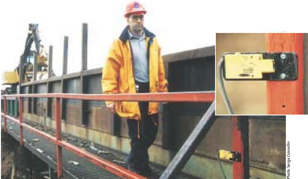
Sur la passerelle de la chargeuse Tanguay, un œil magique déclenche un avertisseur sonore. Le son informe les travailleurs qu'ils ne peuvent s'engager sur la passerelle. À cause du bruit ambiant, le conducteur de la machine, assis dans son habitacle, pourrait ne pas entendre cette alarme. Un avertisseur visuel a donc été ajouté en guise de mesure supplémentaire de sécurité. Claude Laprise, surintendant des ressources humaines et de la prévention, circule sur la passerelle en toute sécurité.
