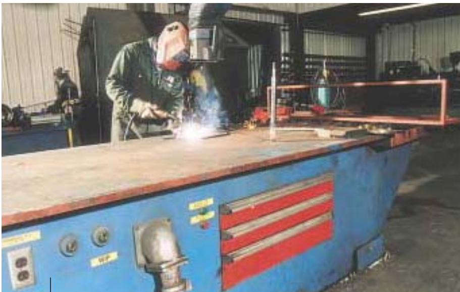
Pierrot Lambert, mécanicien et représentant au comité de santé-sécurité, effectue une soudure. Un aspirateur intégré à la table gobe les cendres et les débris de métal qui aboutissent dans un cendrier amovible. Les prises électriques font corps avec la table.
