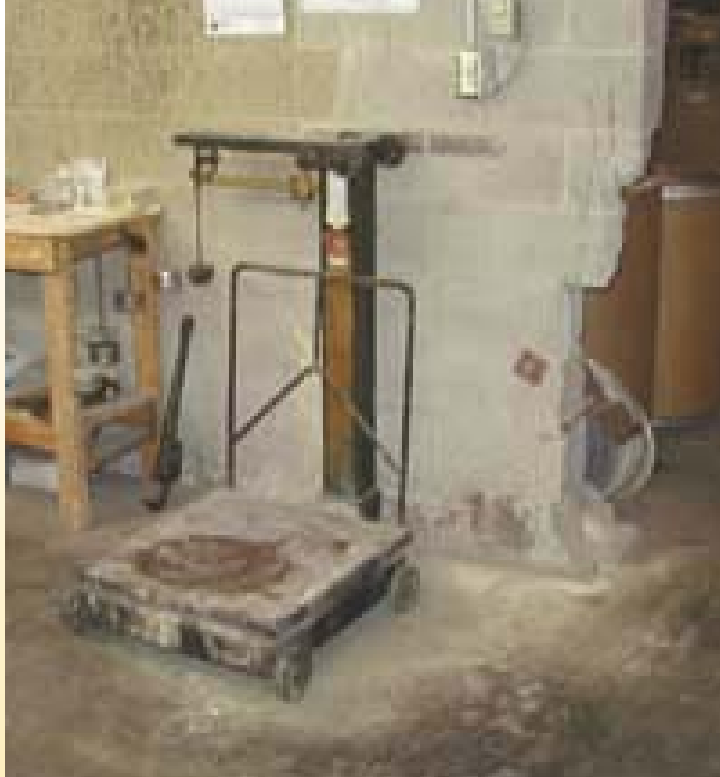
Avant. Le travailleur devait hisser les barils sur la balance à bascule. Manœuvre risquée pour le dos.
