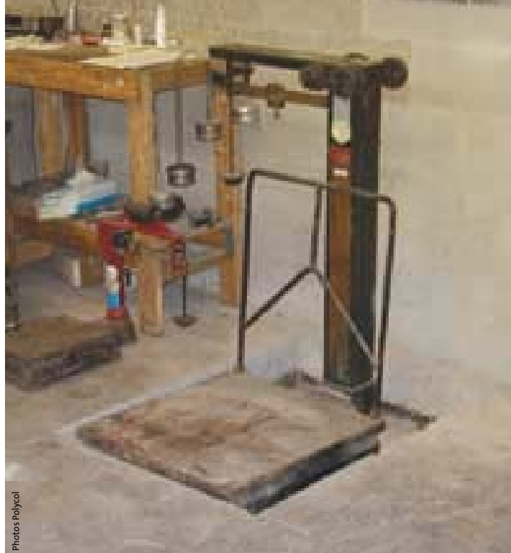
Après. Le plateau de la balance ayant été encastré dans le plancher, le travailleur n'a plus qu'à faire rouler le baril.
