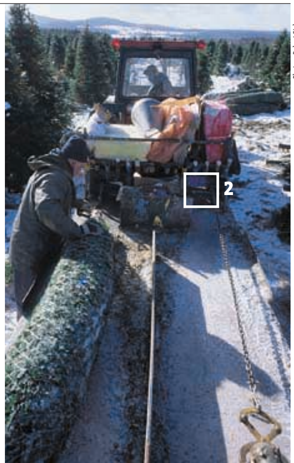
L'emballeuse vue de dos. On voit bien la prise de force et le grillage protégeant l'accès au treuil. Ce dernier est muni d'un dispositif sensible d'arrêt d'urgence.
