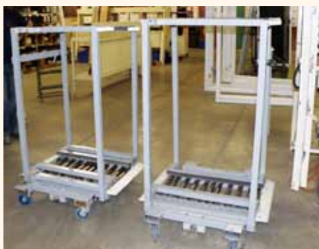
Ces deux chariots permettent d'effectuer le transport des portes-fenêtres en toute sécurité.
